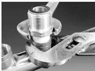
Figure 4.3 Soutien approprié du collecteur lors de l'installation des raccords
